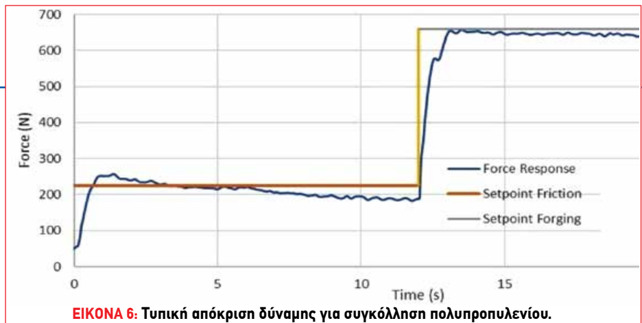
ΕΙΚΟΝΑ 6: Τυπική απόκριση δύναμης για συγκόλληση πολυπροπυλενίου.
