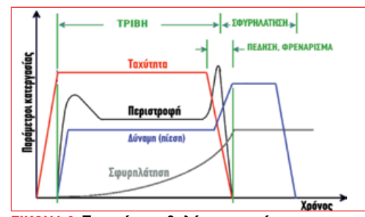
ΕΙΚΟΝΑ 2: Τυπική μεταβολή μηχανικών μεγεθών με τις φάσεις κατεργασίας.
