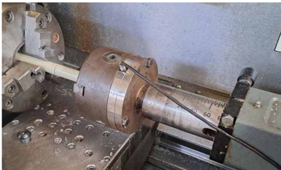
ΕΙΚΟΝΑ 3 (ΑΡΙΣΤΕΡΑ): Το τσοκ του κεντροφορέα με αισθητήρα δύναμης.
