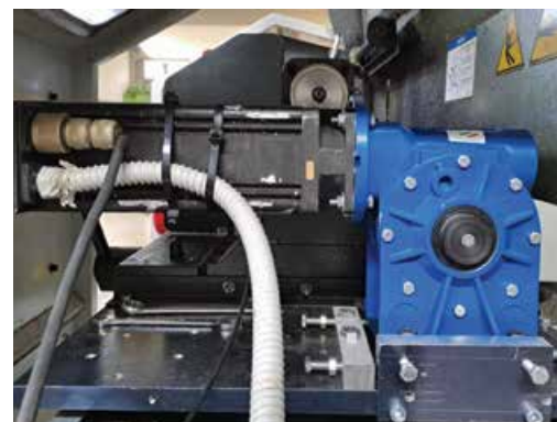
ΕΙΚΟΝΑ 3 (ΑΡΙΣΤΕΡΑ): Το τσοκ του κεντροφορέα με αισθητήρα δύναμης.
