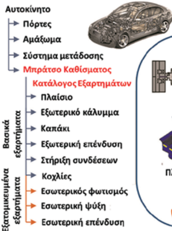
ΕΙΚΟΝΑ 2. Εξαρτήματα και διεργασίες συναρμολόγησης μπράτσου καθίσματος αυτοκινήτου.
