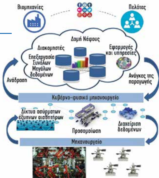
ΕΙΚΟΝΑ 4. Αρχιτεκτονική εφαρμογής τεχνολογιών υπολογιστικής νέφους στην παραγωγή.
