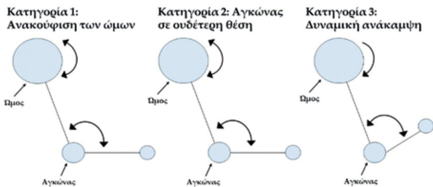
ΕΙΚΟΝΑ 3: Οπτικοποίηση της κινηματικής πλεονασματικότητας (7-DOF) και των αντίστοιχων εργονομικών «φωλιών» (Shoulder-Relief, Elbow-Neutral, Dynamic Recovery) που εντοπίζονται μέσω του αλγορίθμου MMFSA για την ανακατανομή του μυοσκελετικού φορτίου σε πραγματικό χρόνο.
