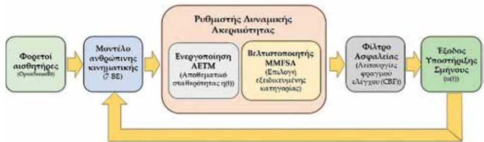
ΕΙΚΟΝΑ 2: Αρχιτεκτονική του συστήματος Dynamic Integrity Governor (DIG), το οποίο ενσωματώνει αισθητήρες πραγματικού χρόνου και αλγόριθμους τεχνητής νοημοσύνης (ΑΕΤΜ, MMFSA) για τη δυναμική διαχείριση του εργονομικού φορτίου.
